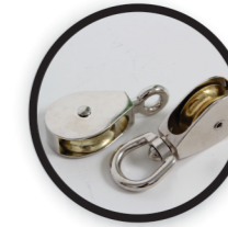
Polea tipo Campbell capacidad 550 Lbs (ó 250kg) para cable de 3/8" de diámetro máximo
